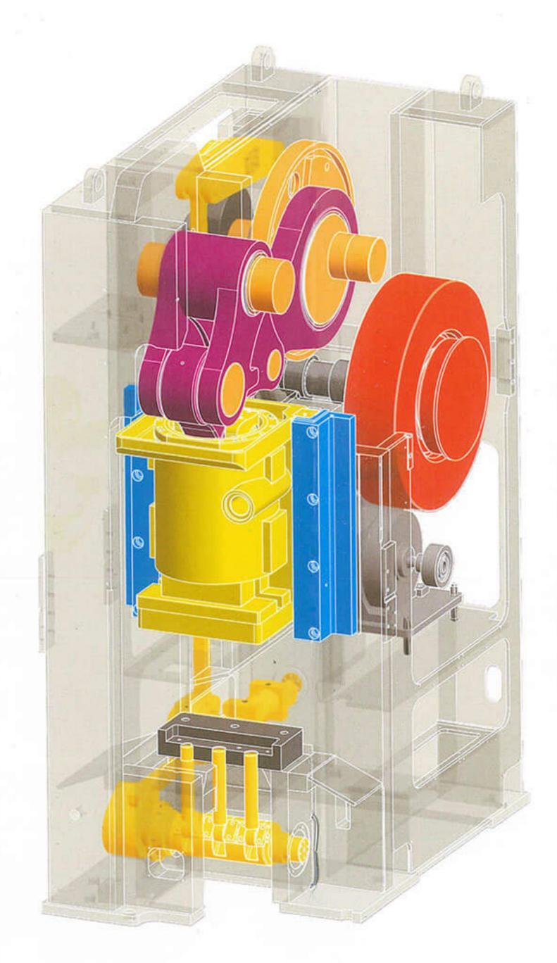
採用高剛性製作技術,特級品質大齒輪,肘節機械理論, 調整螺桿以及滑塊接點,這些特點使得整體間隙只有傳統 沖床之1/3
